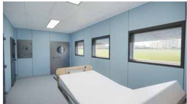
Patientenzimmer mit Patienteneintrittsschleuse; Transferbox für den Probentransfer zum BSL-3-Labor
